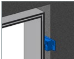
KEILE werden z.B. bei der Türrahmen-Montage eingesetzt
